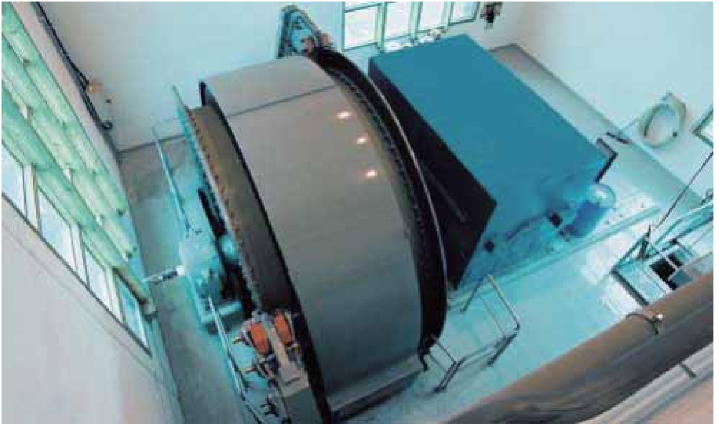
图4. 直径为4.5米、带同步电机变频器的摩擦传动提升机。
