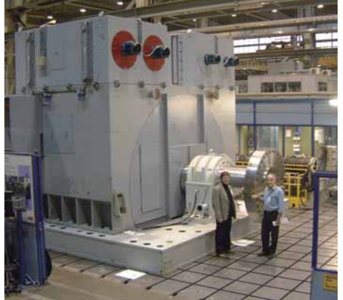
在两台AMZ同步电机（每台电机的额定功率是10 MW）中，图中所示为通过两台ACS 6000单传动变频器控制的一台电机。
