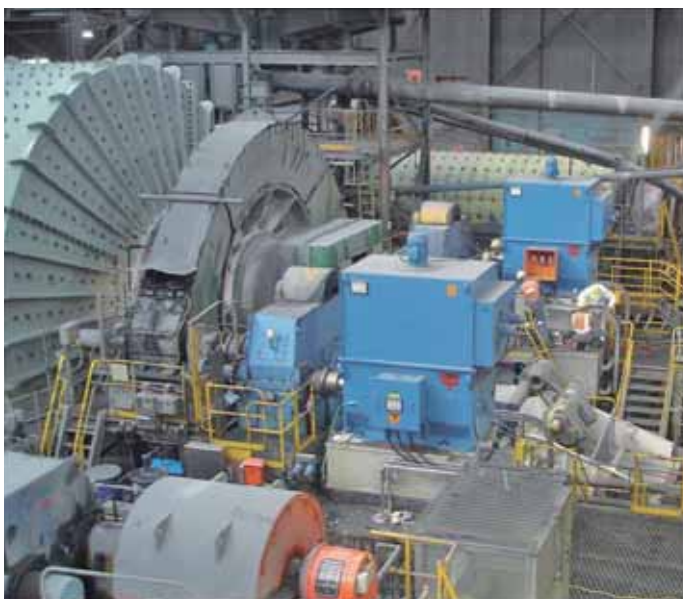
两台双齿轮自动研磨机如今由ABB提供的变频器驱动。
