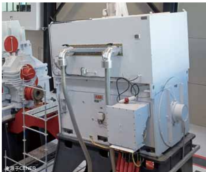
驱动一个CENER试验台的ABB电机
