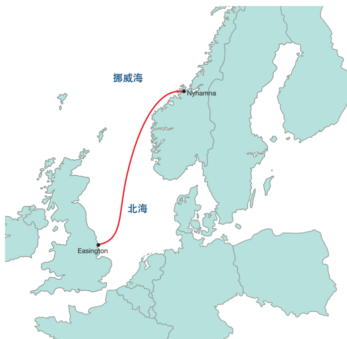
世界上最长的天然气外输管道：天然气将经过1,200公里的距离，从Nyhamna（挪威）输送到Easington（英国）。
